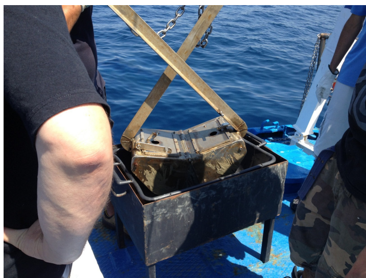
Fig. 4 Prelievo di sedimento tramite benna van Veen
