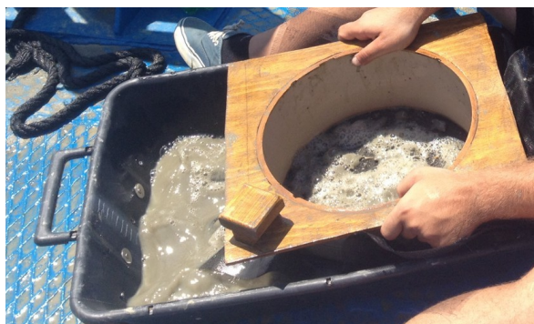
Fig. 5 Setacciatura del sedimento tramite rete con maglia di 1mm
